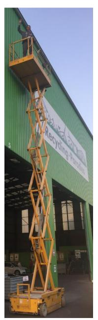
Die Scherenbühne Compact 12 erreicht maximale Arbeitshöhe von 12 Metern.
